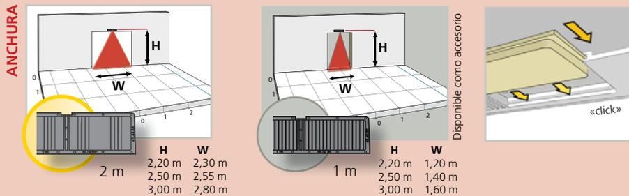
La anchura del campo de detección está conforme con las condiciones definidas en la norma EN 16005 e incluye las dimensiones del test body CA.
