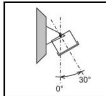
Pour obtenir un lobe de détection proche de la porte, régler l'angle d'inclinaison de l'antenne sur  $30^\circ$ .
