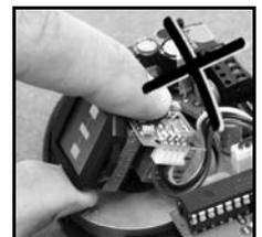
Eviter tout contact avec les parties électroniques (décharges électrostatiques).
