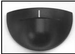
La LED clignote durant quelques secondes après la mise sous tension du détecteur, et clignote durant une configuration par télécommande.
