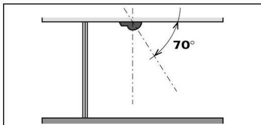
Cet appareil peut être monté au plafond à condition de placer la partie sphérique du détecteur dans la direction opposée de la porte. En plus, un angle vertical d'environ 70° doit être choisi pour l'antenne.
