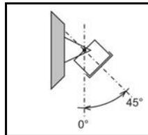
Pour obtenir un lobe de détection éloigné de la porte, régler l'angle d'inclinaison de l'antenne sur  $45^\circ$ .
