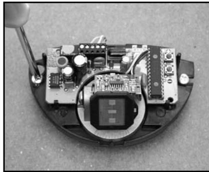
Positionner le détecteur et serrer les 2 vis de fixation. Laisser suffisamment de longueur de câble pour atteindre le bornier.
