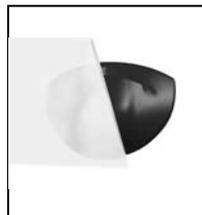
Ne pas placer le détecteur directement derrière un panneau ou un matériau quelconque.
