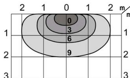
**C. LES DIMENSIONS (LARGEUR, PROFONDEUR, ZONE MORTE) DU LOBE DE DETECTION DEPENDENT DE LA HAUTEUR D'INSTALLATION**
