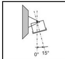
Pour obtenir un lobe de détection le plus proche possible de la porte, régler l'angle d'inclinaison de l'antenne au minimum ( $0^\circ$  à  $15^\circ$ )
